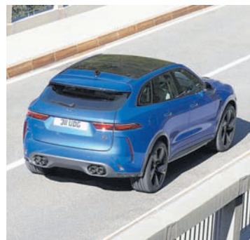
aus. Mit Hilfe eines Twin Vortex-Kompressors leistet er 405 kW (550 PS), legt aber beim Drehmoment um 20 auf maximal 700 Nm (ab 3500 U/min) zu. Als Folge beschleunigt der neue F-PACE SVR nun in 4,0 Sekunden von 0 auf 100 km/h – 0,3 Sekunden schneller als der Vorgänger. Die Höchstgeschwindigkeit stieg um 3 auf 286 km/h.
